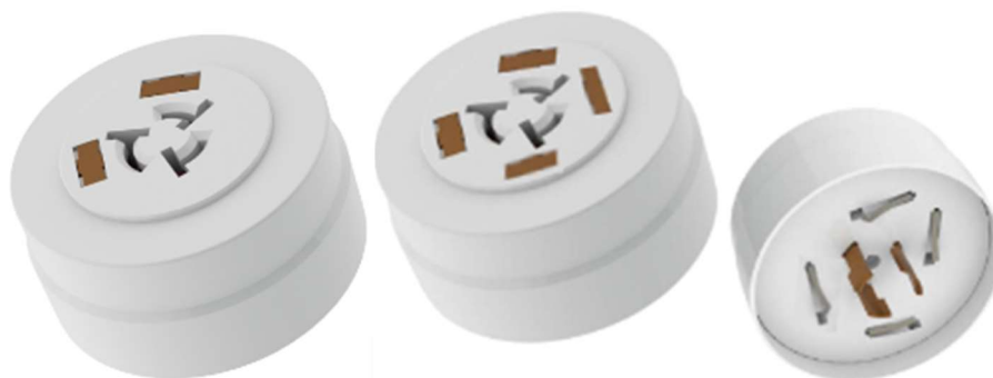
Figura 2 – O equipamento localizado à esquerda da imagem se trata do Bloq Volt + que é utilizado para fins de proteção contra os efeitos das subtensões e sobretensões duradouras. Já as imagens à direita são do DPS NEMA, é um dispositivo de proteção contra surtos, classe II, que deve ser instalado externamente às luminárias e com auxílio de base externa NEMA de 7 pinos.
