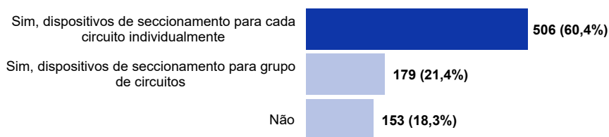
Figura 28 - Presença de dispositivos de seccionamento nos condutores vivos dos circuitos finais.
